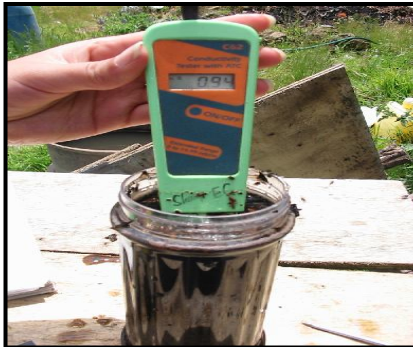
Foto 3. Medición de la variable CE uS/cm en campo
