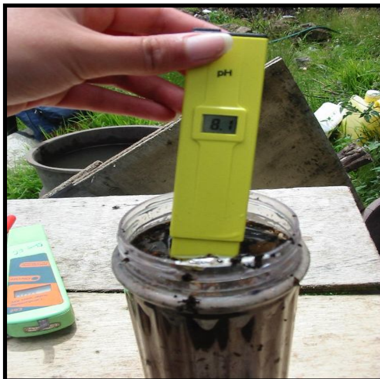
Foto 2. Medición de la variable pH en campo
