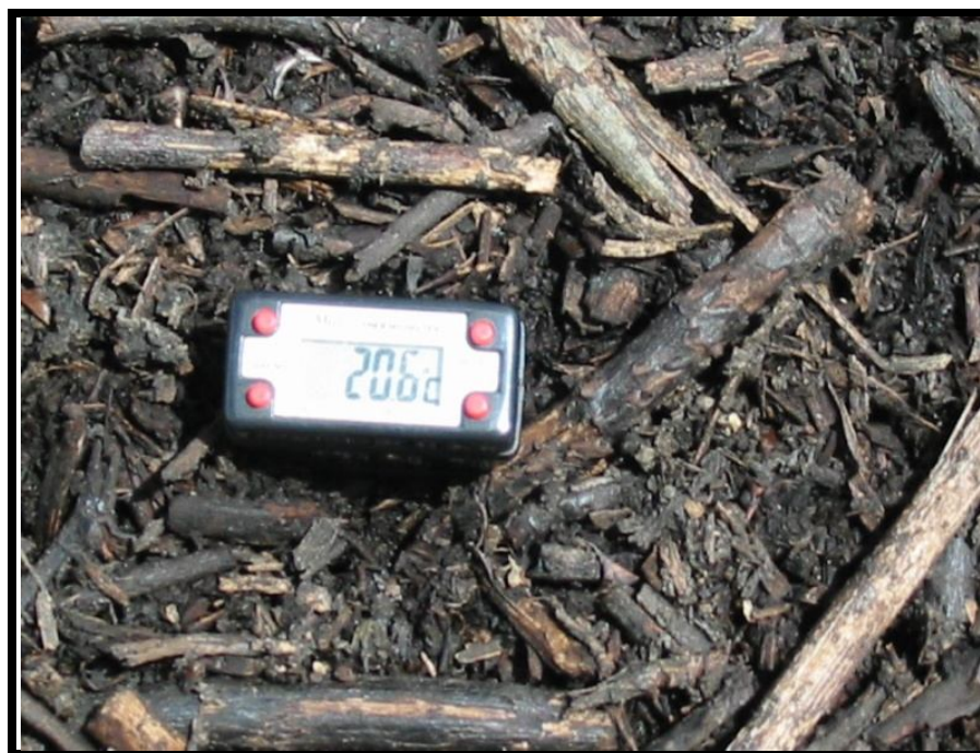
Foto 4. Medición de la variable T °C en campo
