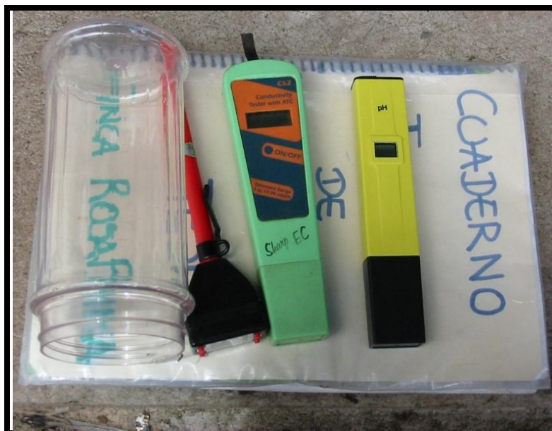
Foto 1. Instrumentos utilizados en campo para la medición de las variables de pH, CE y Temperatura.
